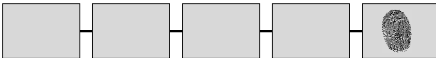
Abb. 2: Einsatz eines Hashwerts, um Diplome zu validieren. Aus dem Diplom wird ein Hashwert berechnet. Bei ihm handelt es sich um eine Prüfsumme, die sich bei der kleinsten Manipulation verändern würde. Zur Absicherung wird diese Prüfsumme auf einer Blockchain unverändert gespeichert. Damit lässt sich das Diplom unabhängig von der Universität validieren. Umgekehrt lässt sich aus dem Hashwert jedoch kein Diplom rekonstruieren.
